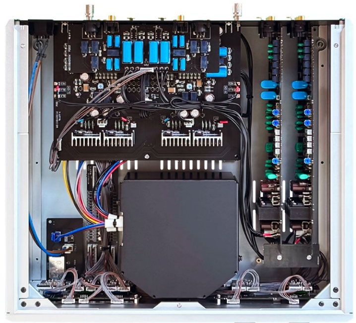
Auch die Unterseite zeigt einen sauberen, kanalgetrennten Aufbau und den Blick auf den gekapselten 400-VA-Ringkerntrafo.
