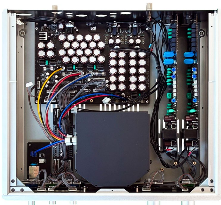
Von oben betrachtet sieht man zahlreiche kleine Elkos, rechts die hochkant eingebauten Verstärkerplatinen und mittig den mächtigen Trafo.
